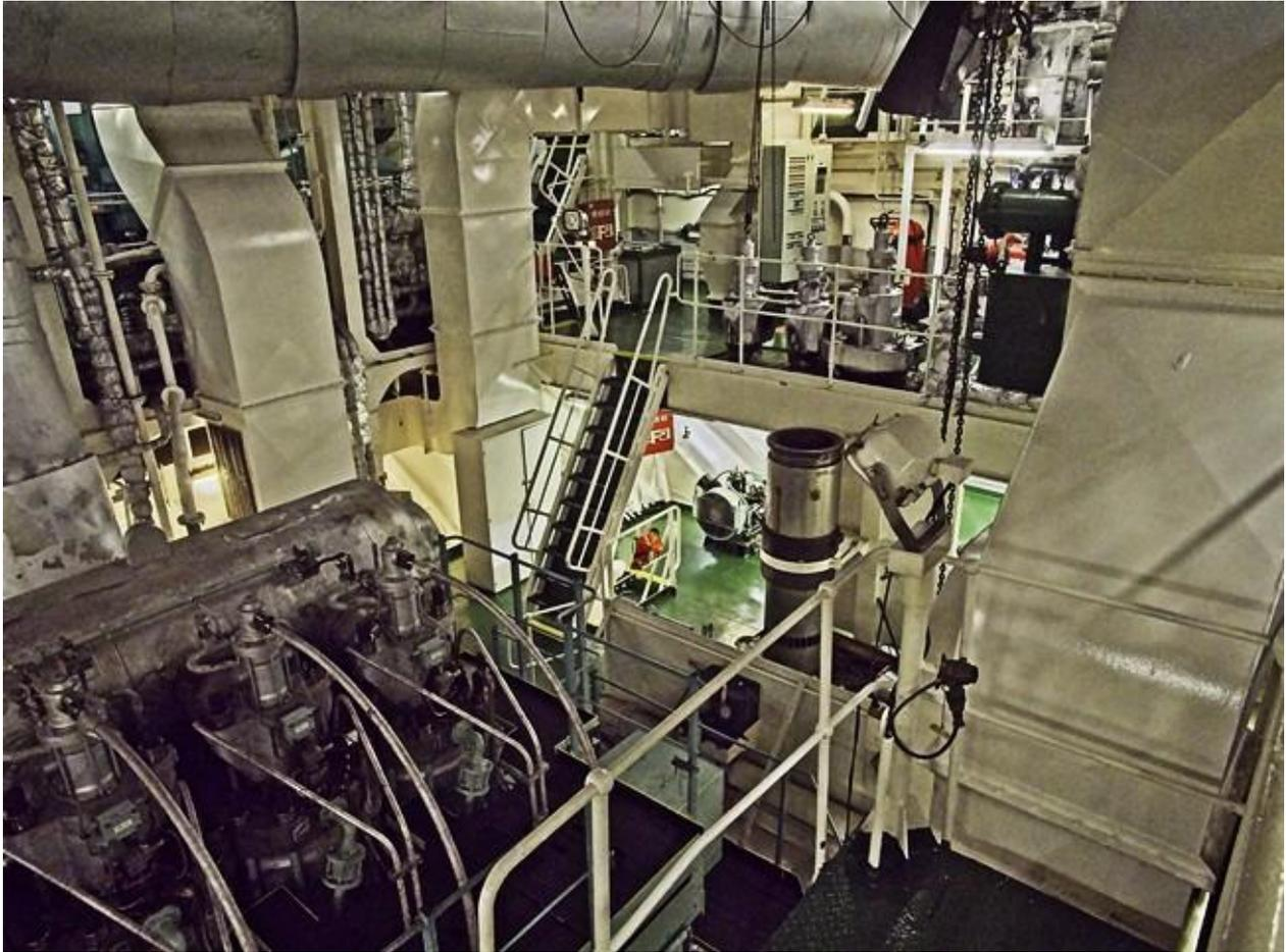
Elektrizität wird über drei große Dieselgeneratoren erzeugt. Sie sind nicht alle gleichzeitig in Einsatz. Einer genügt, um genug Strom für den täglichen Verbrauch zu erzeugen. Wenn die Kräne auf dem Schiff benutzt werden, wird ein zweiter Generator angeschmissen. Der dritte Generator ist redundant, falls einer der anderen beiden ausfällt.
