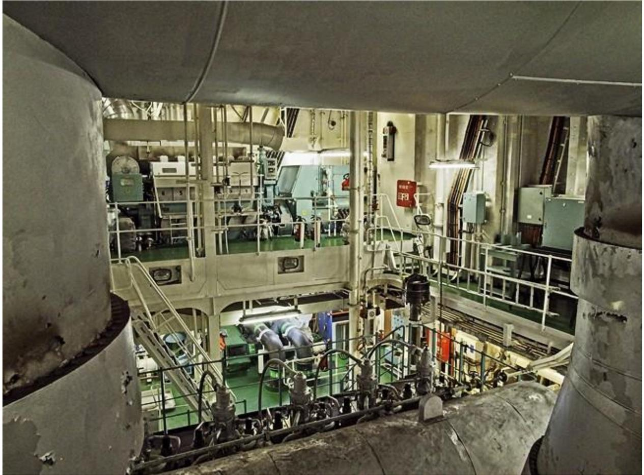
Die Maschine, die das Schiff antreibt, ist drei Stockwerke hoch. Es ist unmöglich, sie als Ganzes zu sehen, denn sie ist, zur einfacheren Wartung, von einem Gerüst umgeben, welches den Ingenieuren erlaubt, jedes Teil zu erreichen.
