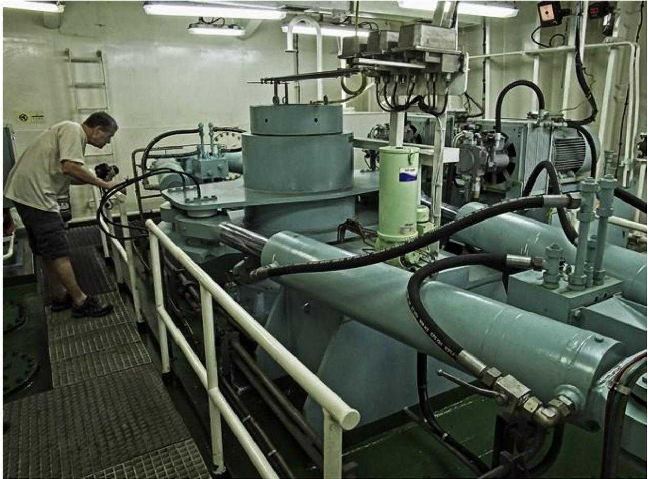
Der Antrieb ist eine Sache, eine andere ist die Steuerung. Das Steuerblatt, auch draußen im Wasser, wird durch eine riesige hydraulische Anlage bewegt.
