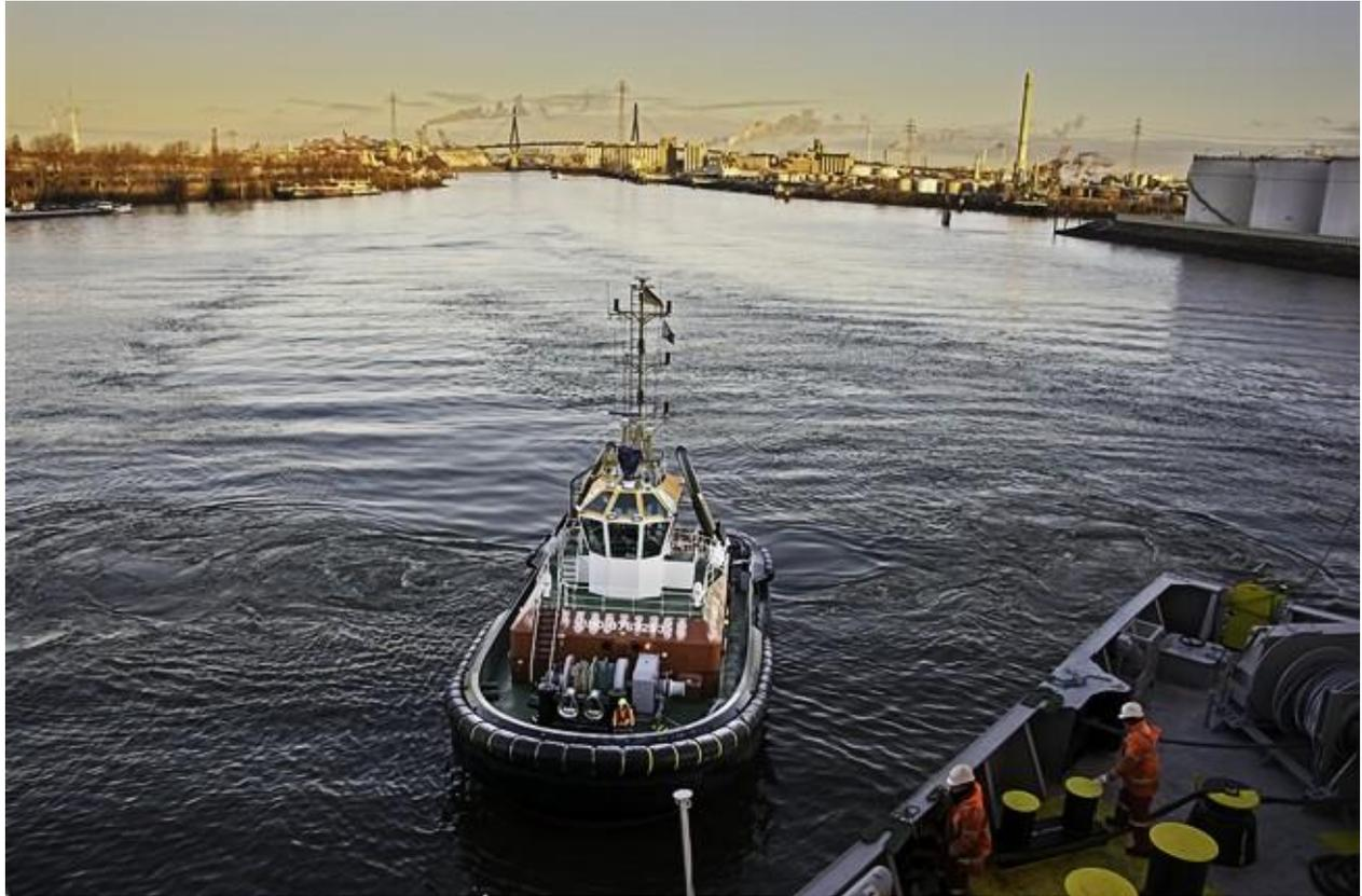
Die Seile der Schlepper werden an dicken Poller auf der *Bright Sky* befestigt. Die Taue, die das Schiff an den Kai fixierten, werden mit großen Seilwinden eingeholt.
