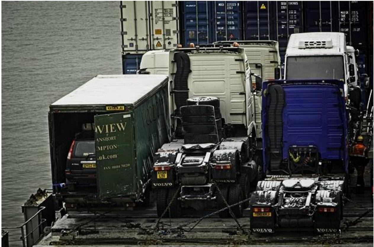
Nach dem Laden ist ein weiteres Team von Männern unterwegs, die die Ladungssicherung kontrollieren. Sitten die Ketten, die die LKWs am Schiff befestigen, stramm? Ist die Containersicherung eingerastet? Nichts darf bei heftigem Seegang verrutschen.
