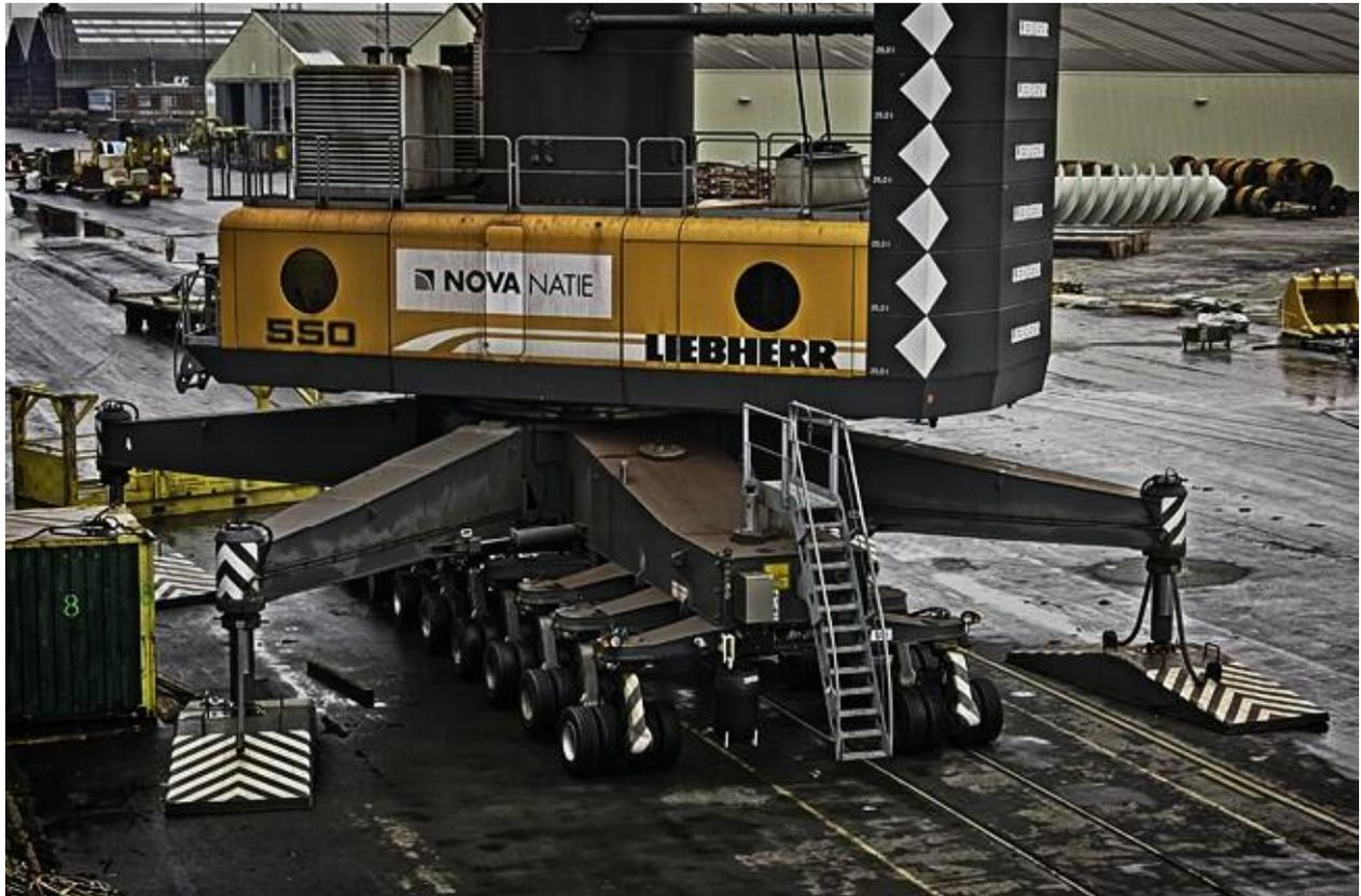
Ein solcher Kran ist vielfältig einsetzbar: von Containern, über Schwerlasten bis hin zu Schüttgut können mit ihm bewegt werden. Eine ausgeklügelte Technik ermöglicht es dem Kranführer seine Lasten schwingungsfrei zu befördern und abzusetzen.
