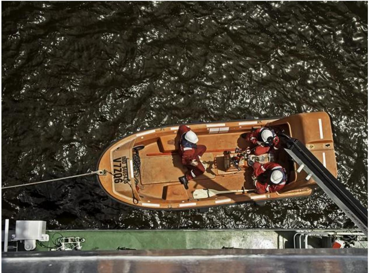
Als Nächstes wird beim großen Rettungsboot geprüft, ob der Auslösemechanismus funktioniert. Dafür muss das Boot erst an einem Kran befestigt werden. Schließlich soll es nicht wirklich die sechs Stockwerke runter ins Wasser fliegen. Dann klettert der Third Officer hinein und betätigt den Auslösemechanismus. Er funktioniert, wie er funktionieren soll. Alle sind zufrieden.
